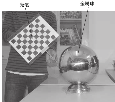
图7 大尺寸金属球的测量实验
