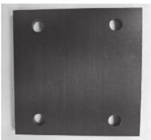
图 8 T300 碳纤维复合材料的单向板
