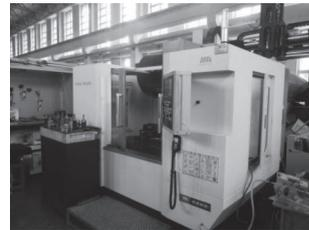
图 10 VMC850E 立式加工中心
