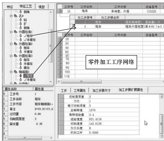
图2 特征加工工步与零件加工工艺中工步的对应关系
