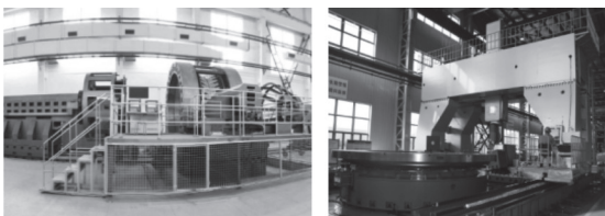
图 17 上海拓璞数控科技股份有限公司研制的筒段、箱底搅拌摩擦焊设备
