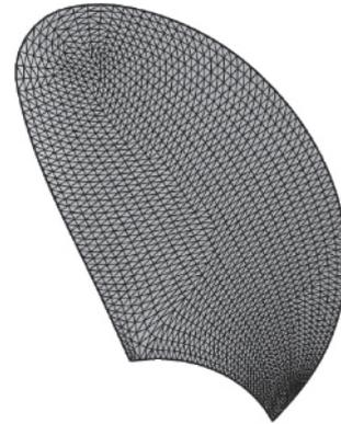
图4 叶片表面网格化
