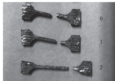
图8 GH4169/K418B复合材料拉伸试验样件
