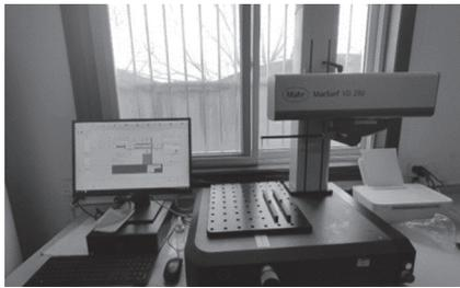
图 12 MarSurf VD 280 型轮廓仪
