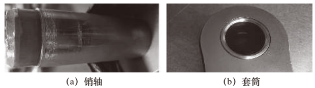
图11 航海试验后磨损情况
