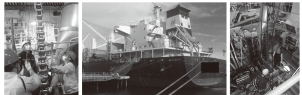
图10 链条安装、试验样船、试验后拆机
