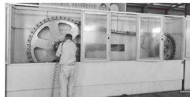
图8 封闭力流式超大规格链条耐磨试验机
