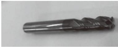
图 4 试验所用硬质合金刀具
