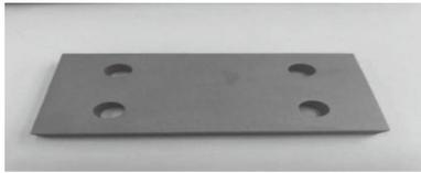
图 3 SLM 钛合金工件
