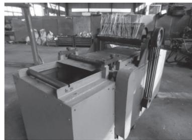
图 12 柔索除锈机实机图
