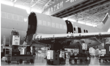
图 15 ARJ21 型飞机大部件对接装配
