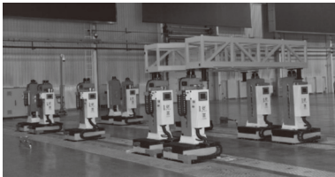
图 16 大部件自动对接柔性装配平台
