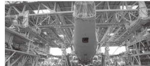
图 6 空客 A350 飞机中机身和前机身段的柔性对接
