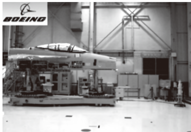
图 4 先进装配技术辅助 F/A-18 战斗机机身对接
