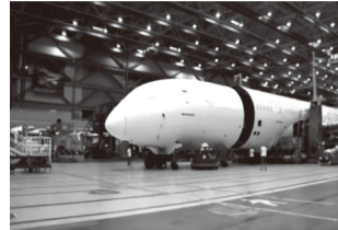
图1 波音787-9客机机身对接装配
